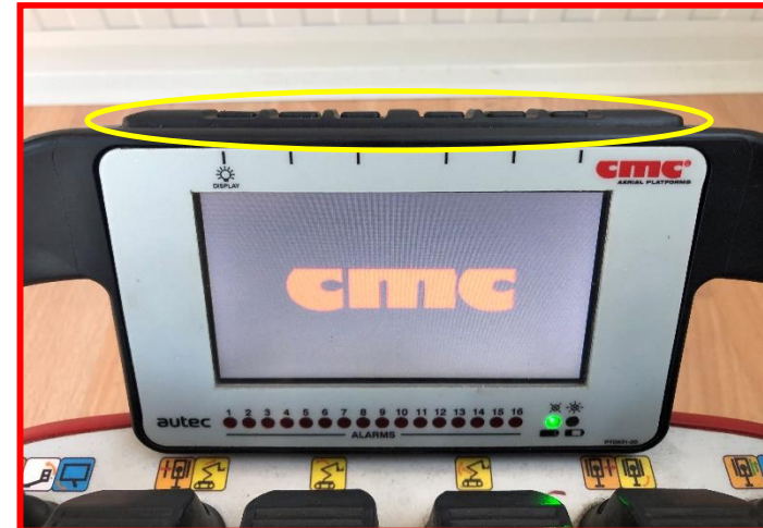
Figure 18 : afficheur de radiocommande.
