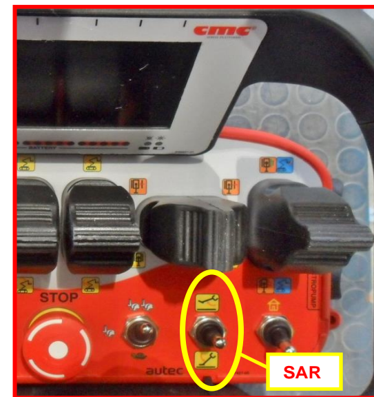
Figure 48 : sélecteur stabilisation/déstabilisation automatique sur radiocommande.
