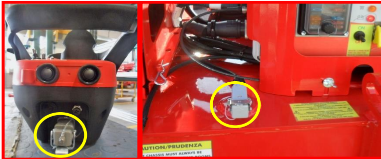
Figure 17 : branchement de la télécommande filaire.
